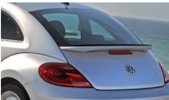
Fällt das Heck eines Automodells eher in rundem Bogen ab wie beim Volkswagen Beetle, kann die Aerodynamik durch einen Heckspoiler deutlich verbessert werden: Die Luft strömt dadurch gerade weg und verwirbelt nicht.
