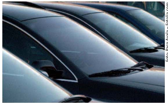
Leicht gewölbte Frontscheiben und abgeflachte A-Säulen sind ein Kompromiss zwischen Aerodynamik und Komfort eines Fahrzeugs.
